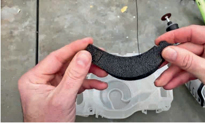
La mousse isolante utilisée dans les appareils Philips se désagrège sous l'effet de l'humidité et de la chaleur.
